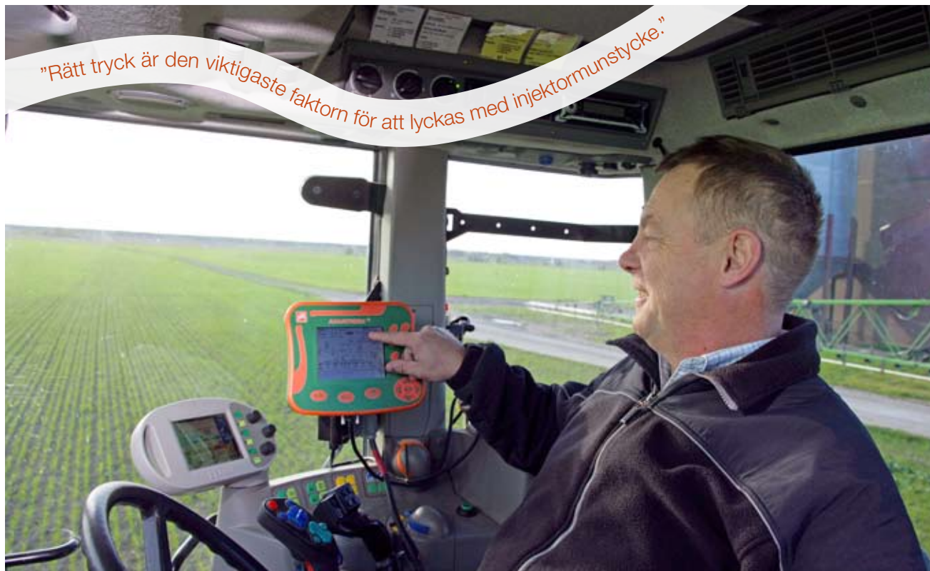
Lars-Håkan Jonsson är noga med att hålla koll på trycket. Fem till sex bar ska det vara, då är betingelserna perfekta för sprutning med injektormunstycken.
